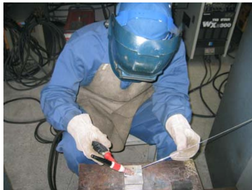
TIG 溶接 (アルミ溶接)
