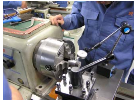
旋盤四ツ爪チャック芯出し作業
