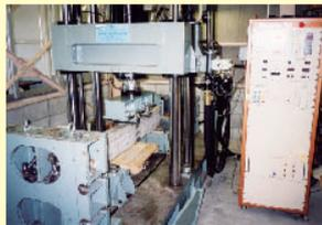
▲30tonf油圧サーボ疲労試験機を用いた
