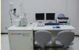
▲走査型電子顕微鏡・X線分析装置
