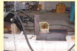
▲RC梁の水平载荷試験
