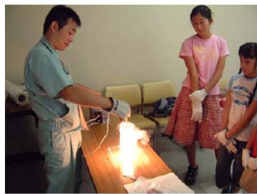
写真7-2 液体窒素中にシャープペンシル芯を入れ 電気を流すと発光する
