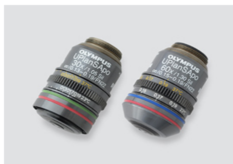
UPLSAPO30XS UPLSAPO60XS ライブイメージング用のシリコン浸対物レンズ：生物顕微鏡向けに，世界で初めてシリコンオイルを用い，液浸観察を実現したライブイメージング用のシリコン浸対物レンズをオリンパス株式会社と共同開発。
