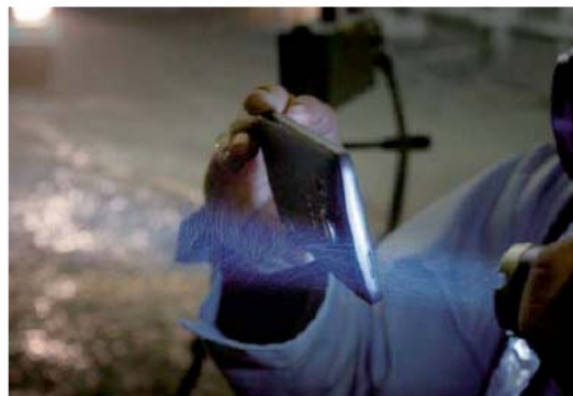
トンネル坑内で粉じん測定をしている状況。LEDライトを当てると浮遊粉じんが光に散乱し白く光っているのがわかります。
