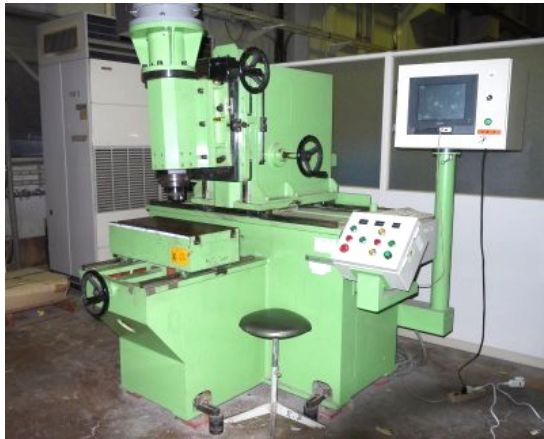
(a) 摩擦攪拌接合装置
