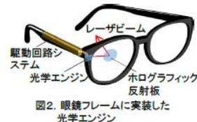
図2. 眼鏡フレームに実装した光学エンジン
