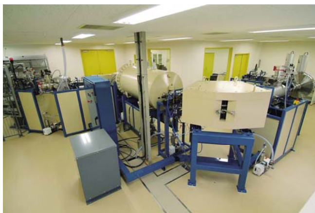
【総合研究所に設置した高感度加速器質量分析装置】
