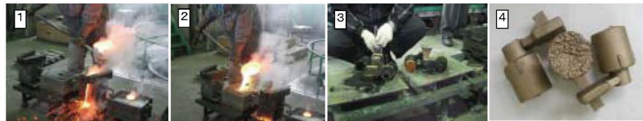
通常の鋳型と凍結鋳型の両方に注湯、鋳型をばらし比較検討している様子。凍結鋳型の特性、品質を実体験で理解することとなる。(㈱光合金製作所と室蘭工業大学によるインターンシップの様子)
