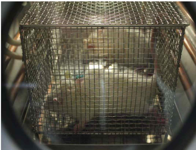
図15 3気圧治療の実験装置 高圧チャンバー (ラット用、DWB-R36, 140L, パロテックハニユウダ)
