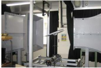
図1 エッフェル型三次元風洞
