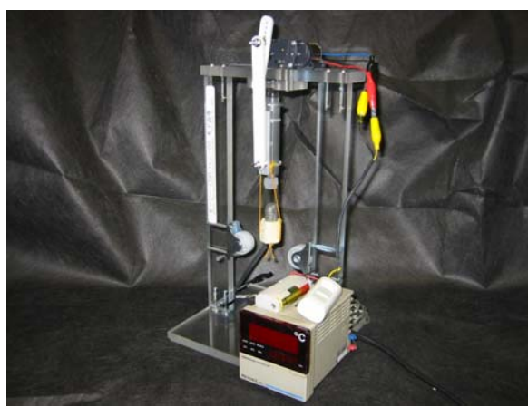
図2 本教育研究にて製作した クーラー（冷凍機）
